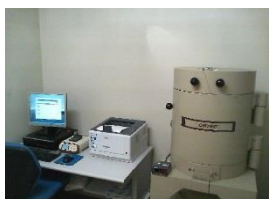
ゲルマニウム半導体検出装置
